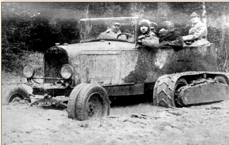
Полугусеничный автомобиль на базе Форда. 1933 год. За рулём Франц Кароль.
