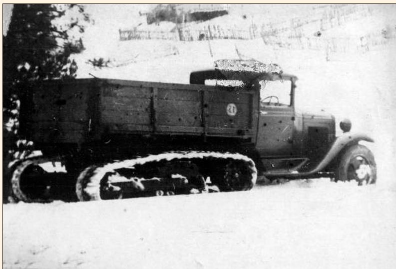
Двигатель Кегресс на шасси ГАЗ-АА ~1934 г.
