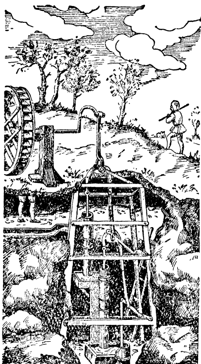
Машина для выкачивания воды из шахт. Из сочинения М. В. Ломоносова «Первые основания металлургии», 1763 год.
