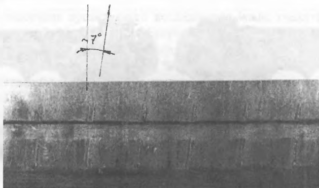
Фотооптическая развертка следов канала ствола на исследуемой пуле, полученная с помощью прибора РМ-4.
