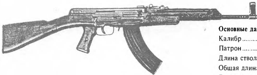
Рис. 3. Автомат системы А.И.Судаева. Опытный образец 1944 г. (Модель 3). Изготовлен в 1944 г. Проходил полигонные испытания в 1944 г.
