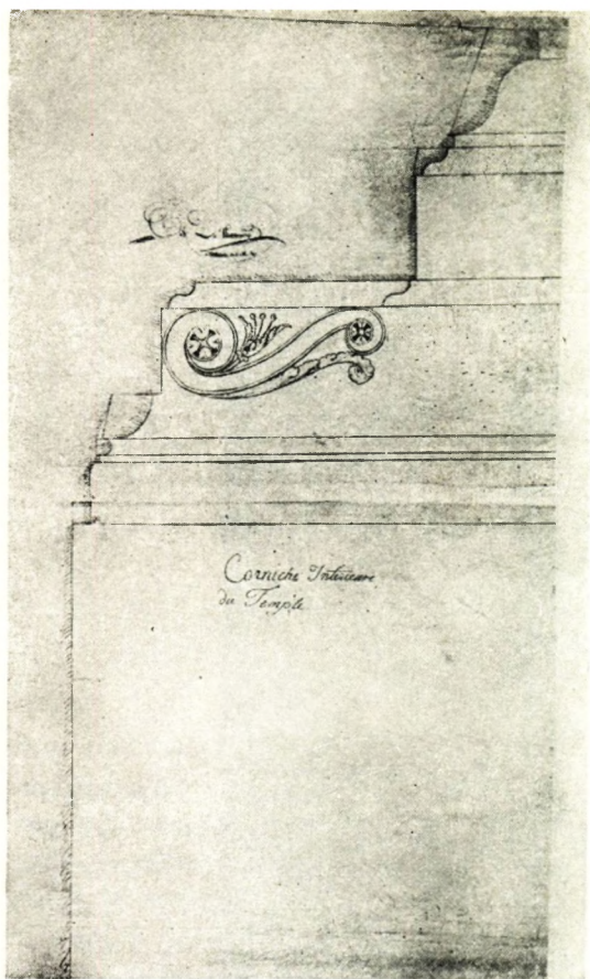
100. Мавзолей «Супругу-Благодетелю». Рабочие чертежи: слева—внутреннего карниза; справа — решетчатой двери
