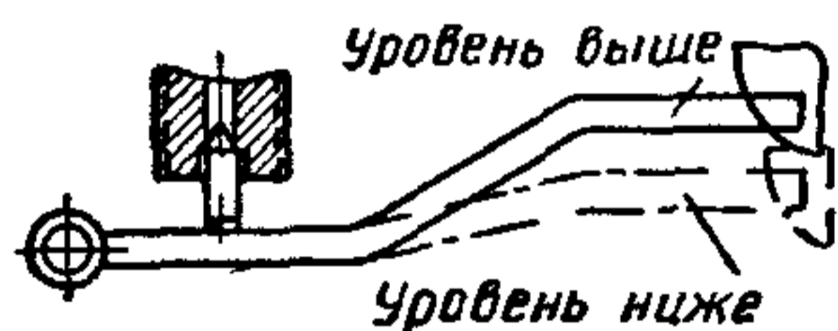
Фиг 173. Регулировка уровня топлива в поплавковой камере карбюратора путем изгиба рычажка поплавка.
