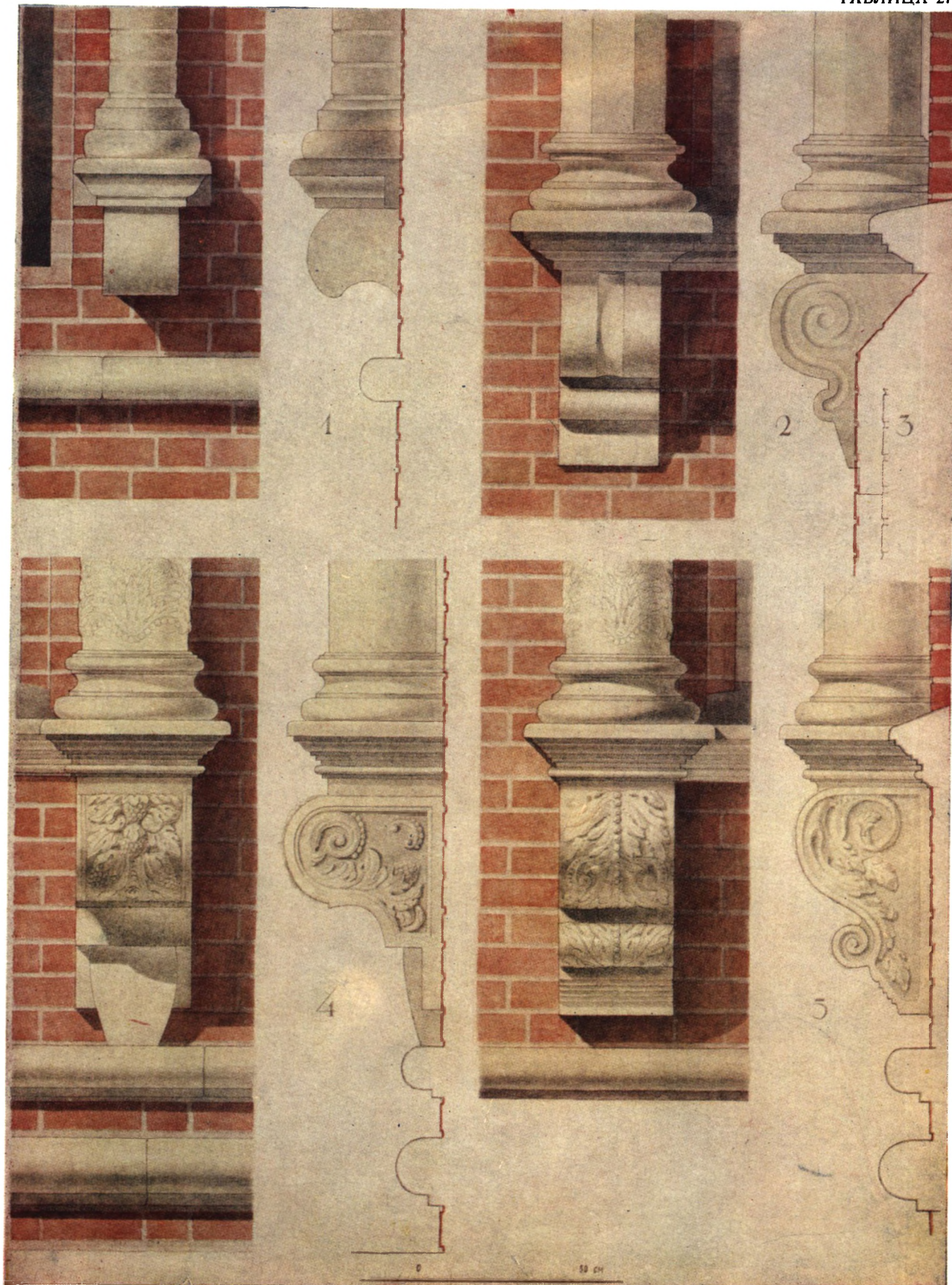
Успенский собор в Рязани. Кронштейны колонн, обрамляющих окна: 1) окна барабанов глав; 2) окна третьего яруса; 3) окна второго яруса; 4 и 5) окна первого яруса (обмер автора)
