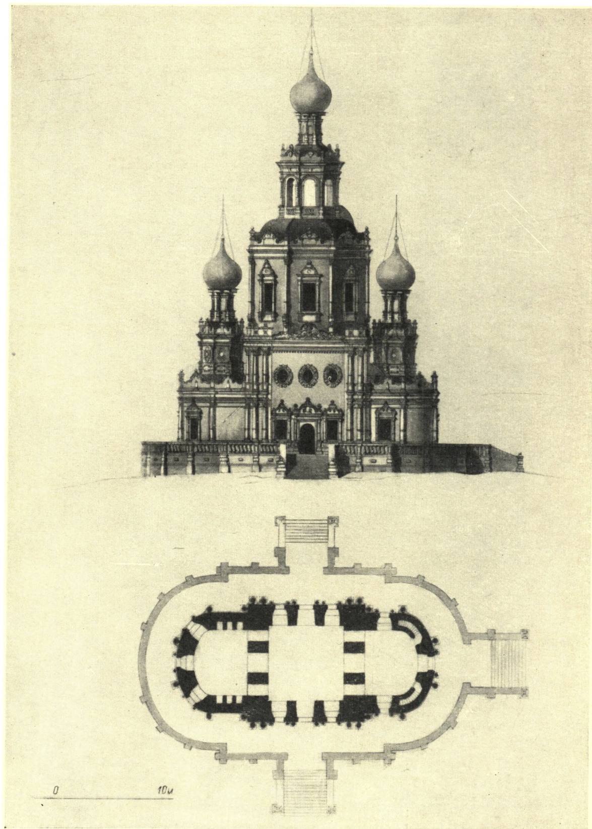
Церковь в селе Троицкос-Лыково. Южный фасад и план (по обмерам В. Подключникова)
