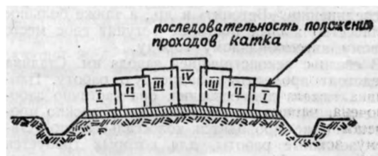
Рис. 3. Последовательность укатки гравийной дороги
